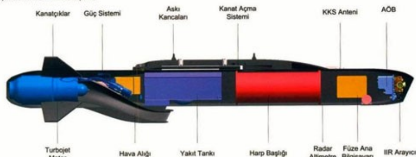
Şekil 1: SOM-B1 mühimmat bileşenleri. Arayıcı başlık dışında, SOM-A'nın bütün bileşenleri SOM-B1 ile aynıdır.
