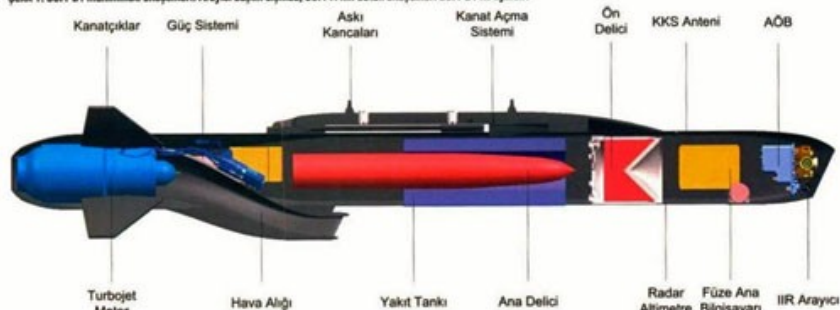
Şekil 1: SOM-B1 mühimmat bileşenleri. Arayıcı başlık dışında, SOM-A'nın bütün bileşenleri SOM-B1 ile aynıdır.
