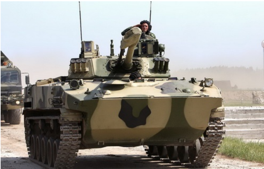
armata niskociśnieniowa 2A70 mająca możliwość wystrzeliwania ppk 9M117M1-3 Arkan, 30-mm szybkostrzelna armata automatyczna 2A72, 7,62-mm czkm PKT)
