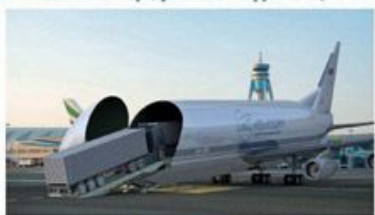
2. Загрузка колесной техники своим ходом
