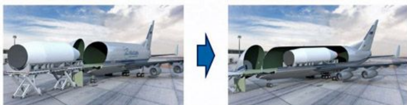
1. Загрузка с использованием аэродромного погрузчика (головной обтекатель)
